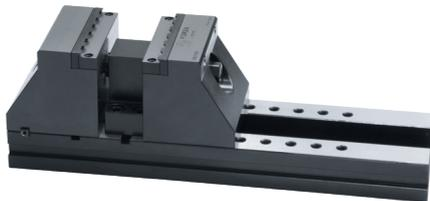
Mordaza idónea para trabajos en 5 ejes donde la pieza a mecanizar se agarre de pocos mm. Fabricada en acero cementado F155.
